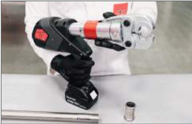
Preparazione della macchina pressatrice / Press machine preparation
